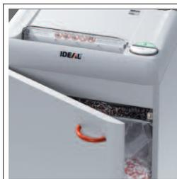
Bei geöffneter Tür wird der Aktenvernichter über einen integrierten Magnetschalter automatisch abgeschaltet.
