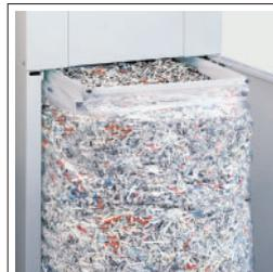
Das komfortable Auszugssystem mit Laufrollen ermöglicht eine bequeme Entnahme des vollen 300-Liter-Auffangsacks.
